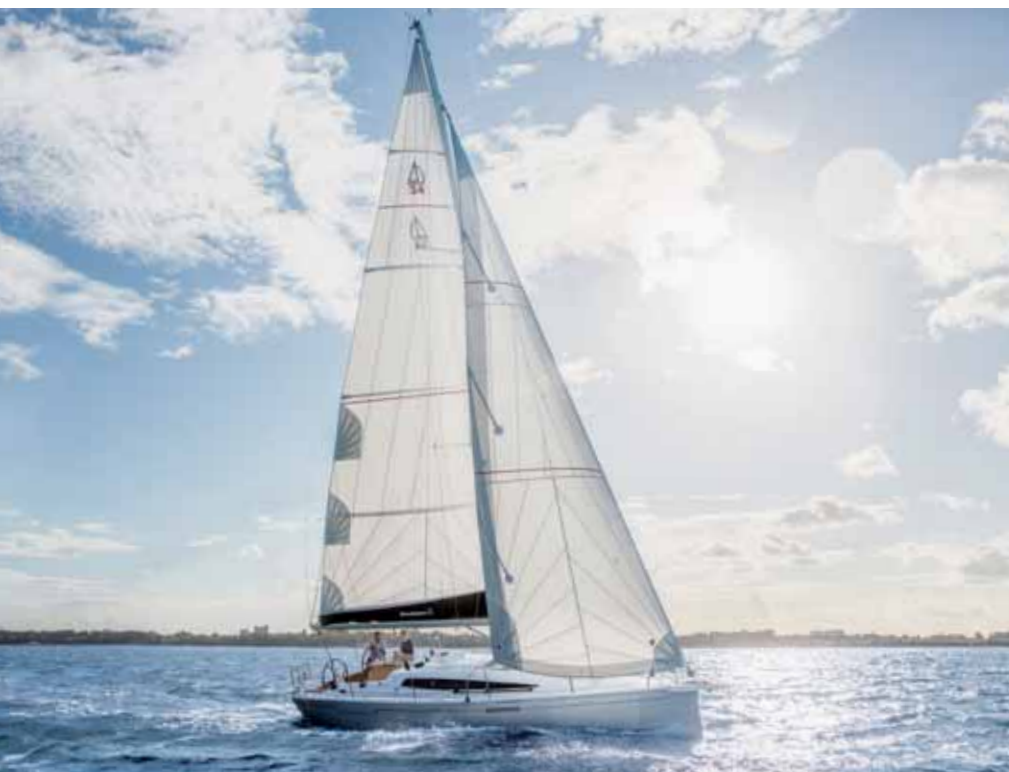
Dehler 34 je oplachtěn jako redukováná šalupa 9/10 s kosátkou 105 %, ale je možné volit buď karbonové kulatiny a kompozitní plachty Elvstrøm HPM, nebo duralové kulatiny a plachty Elvstrøm FCL (na obrázku), oboje triradiálního střihu.
