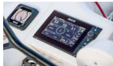
Rekreační verze Dehleru 34 používá přístrojovou sadu Cruising firmy B&G, kterou tvoří dva mapové plotry se špičkovými displeji, autopilot a rádio s bezdrátovým připojením k tabletu nebo ke smartphonu.
