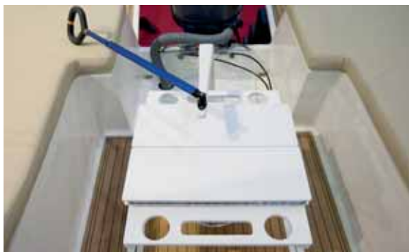
Při plavbě na plachty kormidluje klasickou pínou s výklopným kormidlem. V případě plavby na motor kormidlo jednoduše vytáhnete, hydraulikou motor spustíte do vody a kormidluje již z druhého stanoviště, které je před kokpitem a typické pro motorovou loď.
