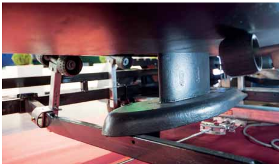
Trup s délkou 5,99 m a šířkou 2,48 m umožňuje snadný transport a díky zcela zatahovacímu balastnímu kýlu také manipulaci.
