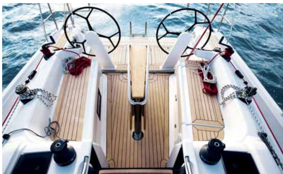
U závodního provedení je do podlahy prostorného kokpitu za kormidelní pákou vsazena kolejnice s jezdcem hlavních otěží.
