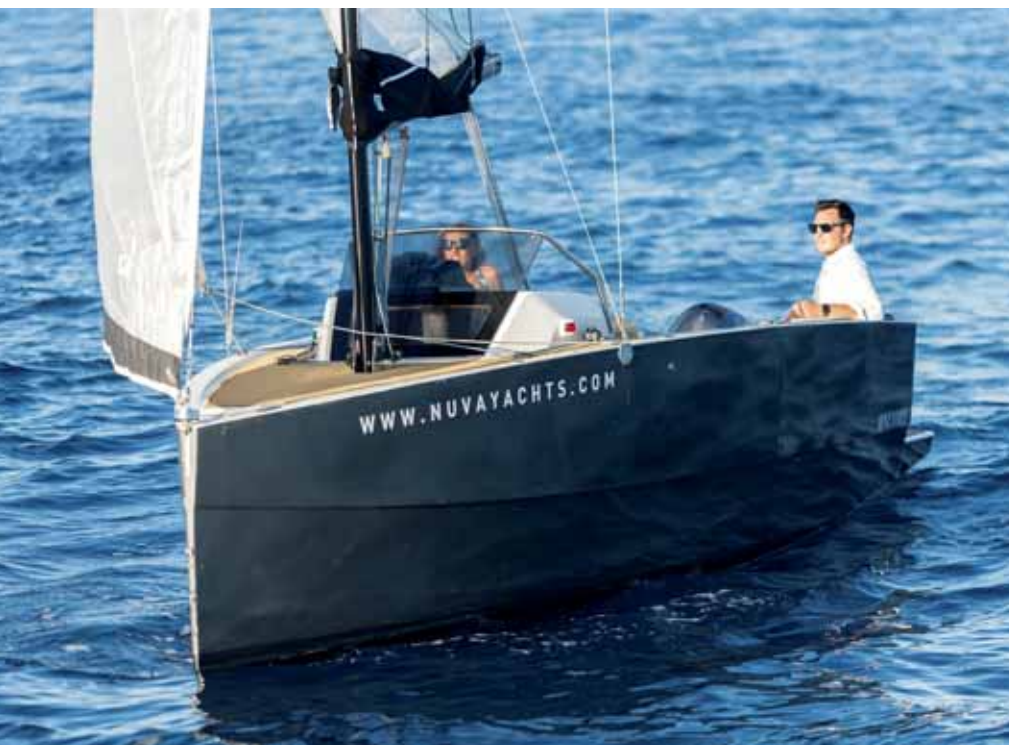
Rolovací příplatková kosatka s plochou 7 m 2 zajišťuje lepší obtékání hlavní plachty, a tedy ještě další zvýšení výkonu.
