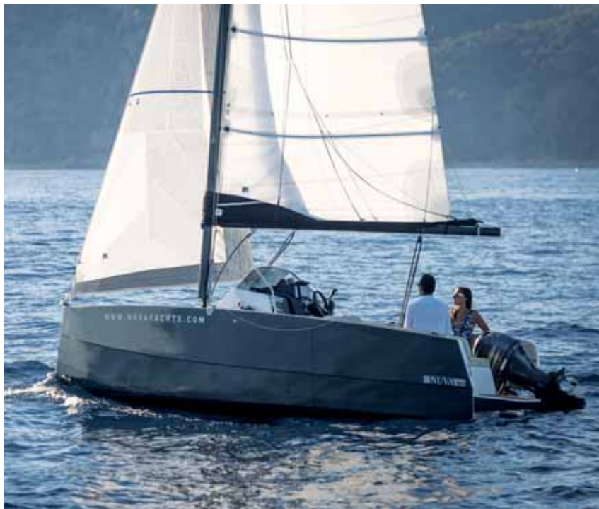
Při plavbě na plachty kormidluje klasickou pínou s výklopným kormidlem. V případě plavby na motor kormidlo jednoduše vytáhnete, hydraulikou motor spustíte do vody a kormidluje již z druhého stanoviště, které je před kokpitem a typické pro motorovou loď.
